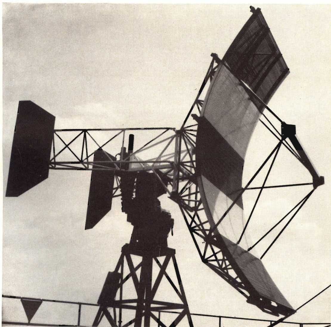
Fig. 3 - Antenna di un radar meteorologico Meteor RMT 50-5A della ditta Selenia di Roma.
